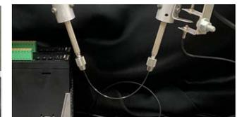
二軸同期型回転曲げ疲労試験
