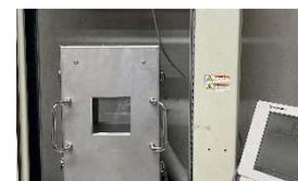
恒温槽を用いた引張試験
